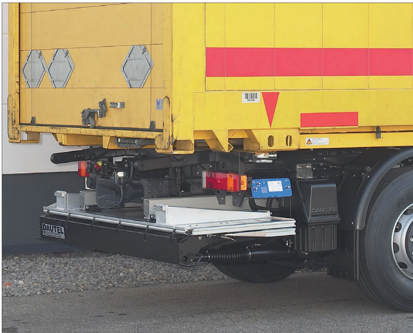
Pozycja gotowości do jazdy, samochód ciężarowy z zabudową wymienną
